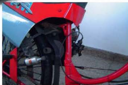
Détail de l'entraînement par galet.
