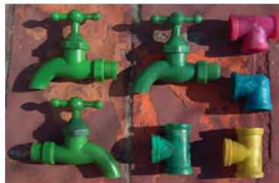
Robinetterie issue d'injection plastique (matières plastiques non alimentaires - colorant de type cirage pour chaussures).
