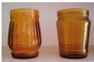
Bouteilles en verre découpée et polissage manuel de la tranche pour obtenir des verres.
