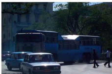
Camello : bus tracté par un tracteur de camion.
